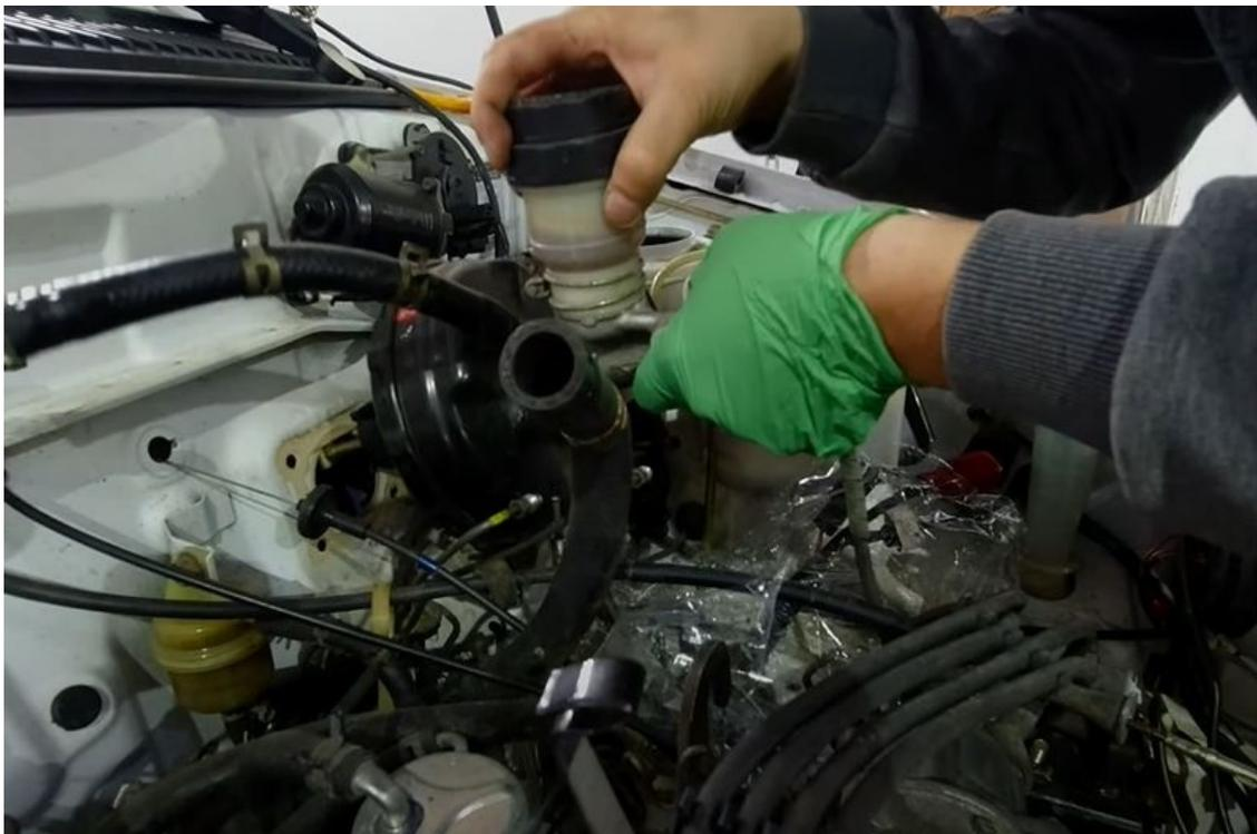
Slika 2. Demontaža originalnog kočnog cilindra
