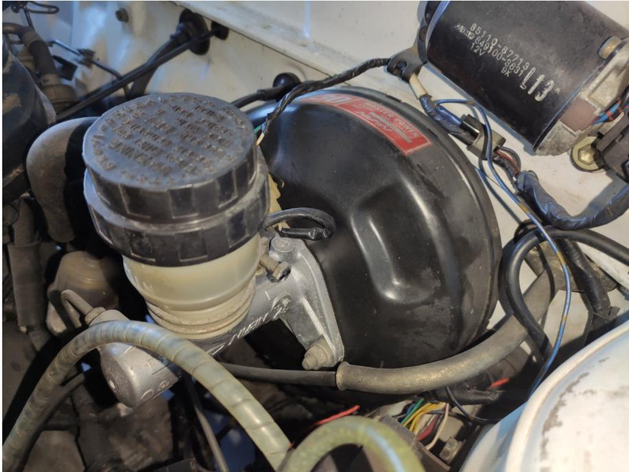
Slika 3. Ugrađen kočni cilindar 13/16
